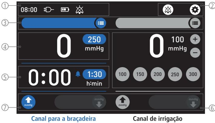
O ecrã principal está dividido em ① barra de estado, ② barra de controlo, ③ barra de canais, ④ painel de controlo da pressão (canal para a braçadeira), ⑤ painel de controlo do tempo de alarme (canal para a braçadeira), ⑥ painel de controlo da pressão (canal de irrigação) e ⑦ painel de controlo para insuflar / desinsuflar.
