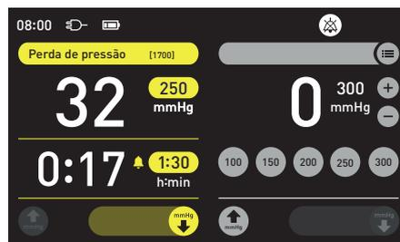
Na barra de canais aparece o erro. O canal para a braçadeira altera entre a cor do canal e amarelo.
