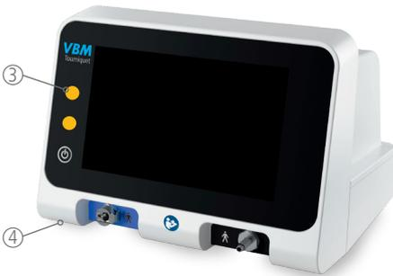
Em seguida, o dispositivo dispara um alarme ótico ③ e um som de alarme ④.
